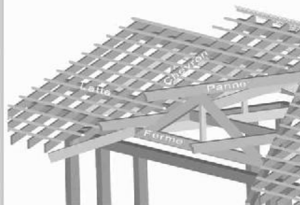
Structure d'une charpente classique
